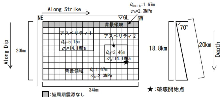
図 32 本検討で使用した震源断層モデルのモデル図 (その 1)
