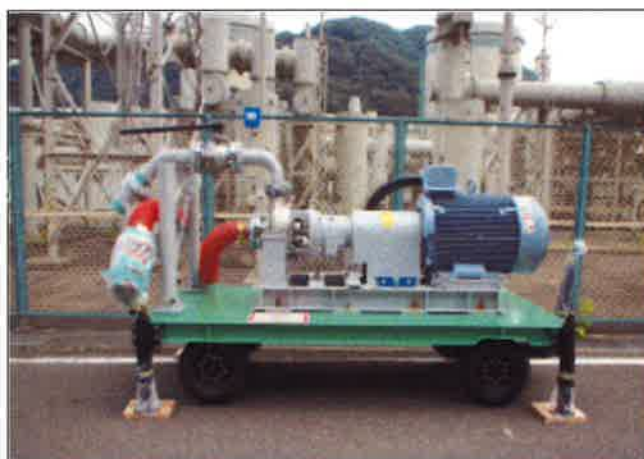
【図表 2 1 可搬式代替低圧注水ポンプ】
